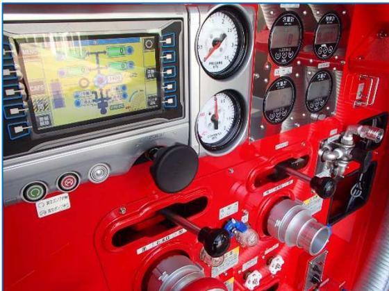
最新のポンプモニターによりポンプの運用状況を把握でき、圧縮空気泡消火装置(CAFS)の各種設定等が可能となっています。
