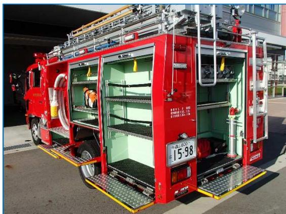
車体の両側面及び後面には各種資機材を積載できるようにシャッター式の収納部となっています。
